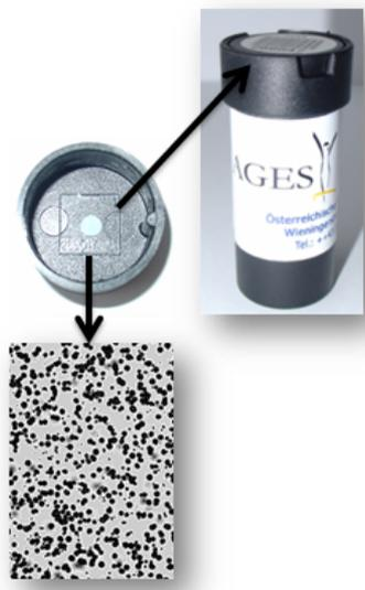
Abbildung 7: Kernspurdetektor und Spuren durch Alpha-Teilchen am Detektormaterial (nach Bearbeitung im Labor)
