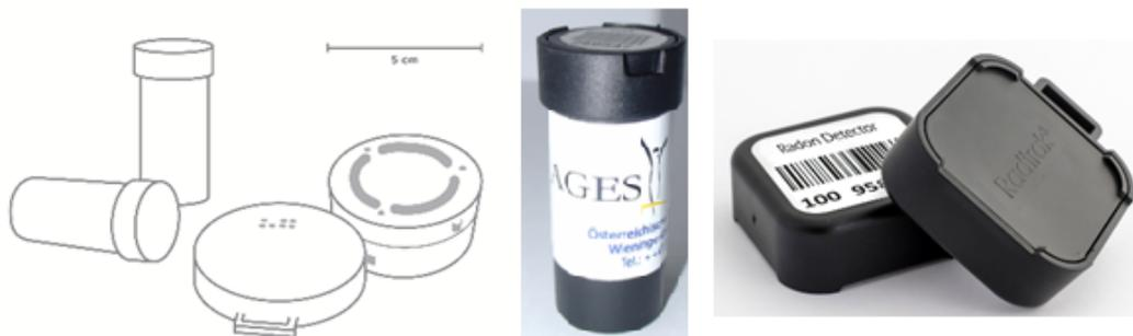
Abbildung 6: Schematische Darstellung von verschiedenen Geometrien für Kernspurdetektoren (links) und Fotos von Detektoren als Beispiel (Mitte und rechts)
