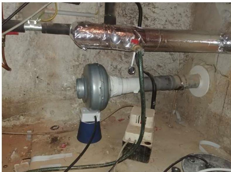
Abbildung 20: Testabsaugung mittels Rohrventilator, Abluftführung über Kamin
