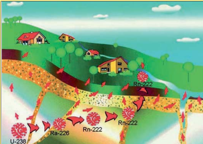
Entstehung und Transport von Radon in der Erdkruste (Bundesamt für Strahlenschutz, Berlin)
