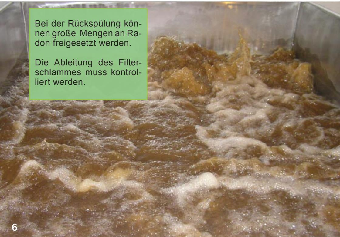
Bei der Rückspülung können große Mengen an Radon freigesetzt werden.
